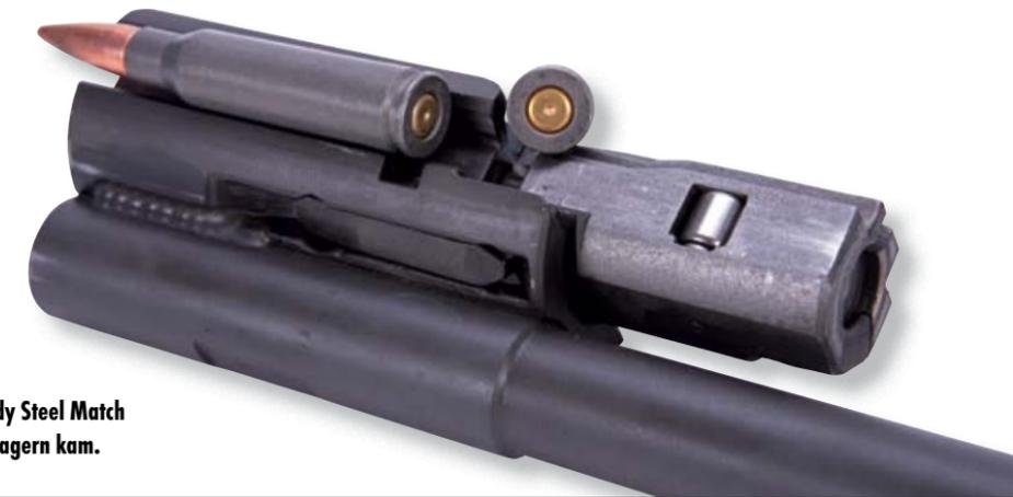
**Der Schlagbolzen der SAR M41 Sportmatch kam mit der Hornady Steel Match Munition mit Stahlhülsen nicht gut klar, so dass es zu Zündversagern kam.**
