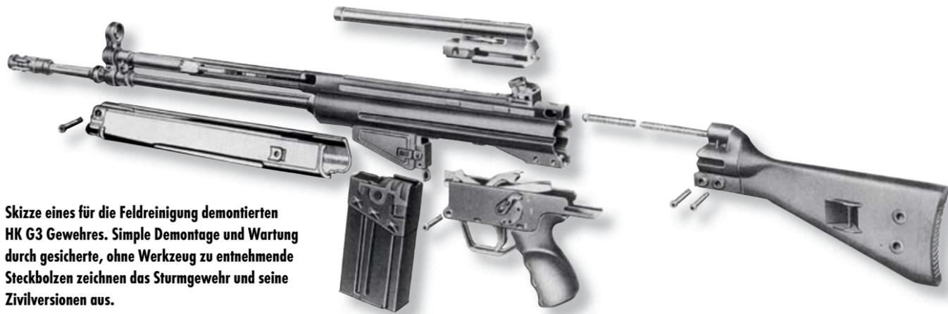
Skizze eines für die Feldreinigung demontierten HK G3 Gewehrs. Simple Demontage und Wartung durch gesicherte, ohne Werkzeug zu entnehmende Steckbolzen zeichnen das Sturmgewehr und seine Zivilversionen aus.
